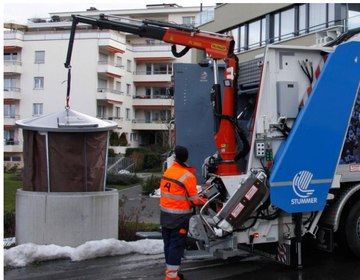
Abb. 5 - Leerung HUFB - Es gibt unterschiedliche Fahrzeuge; bei allen befindet sich der Kranen hinten rechts.
